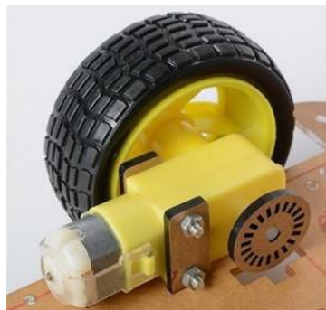
モーターと動輪、ロータリーエンコーダ（底面側から撮影）
