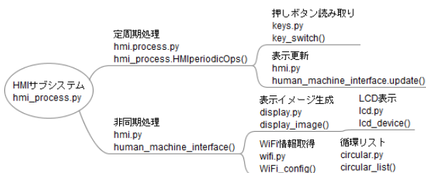
HMIサブシステムの構成
