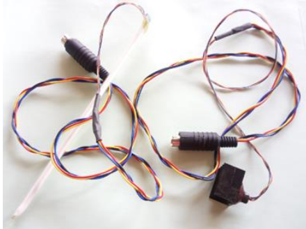
二種類の温度センサ (左: 湯温用、右: 空気用)
