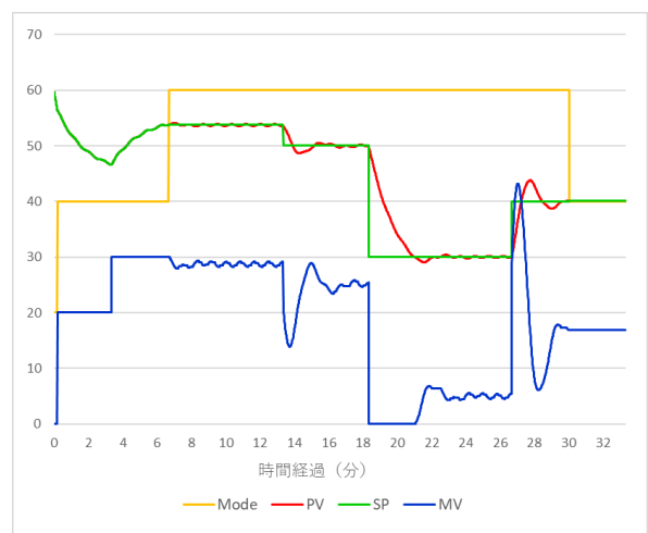
PID 制御の検証結果
