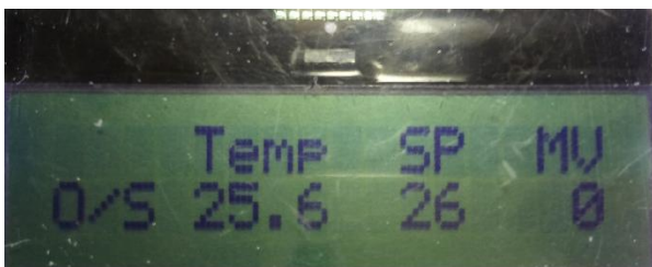
温度コントローラ起動表示
