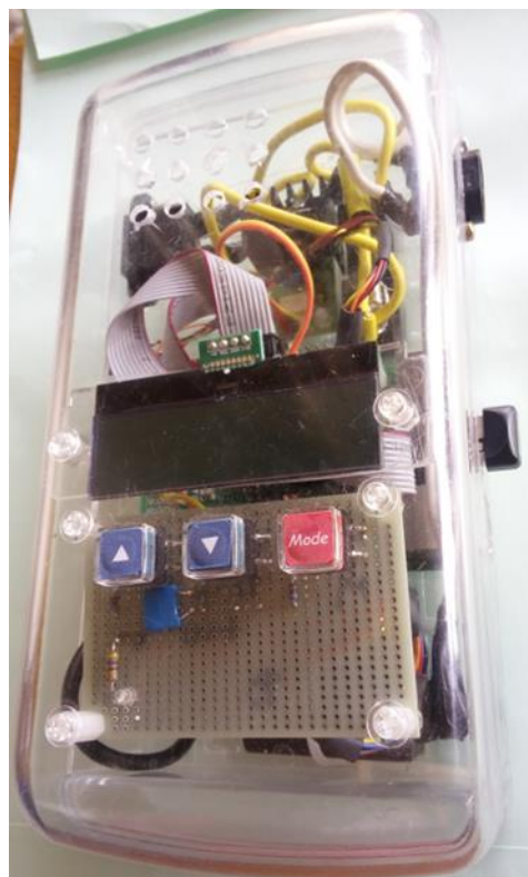
ケースに収納した温度コントローラ
